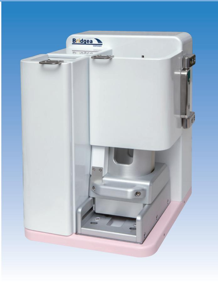
本装置は医薬品製造メーカーより供給される放射性医薬品の専用容器内のバイアルからリクエストに応じた薬液を抜き取り必要な薬液量に調整する装置です。コンテナトレイに専用容器をそのままセットすることができ、必要な放射エネルギーまたは液量を入力することで薬液バイアルの液量を容易に調整することが可能です。薬液量の入力装置は装置外部のコントローラで入力することで放射性医薬品から距離を取りながら作業できるため調整時の手指の被ばくを低減することができます。
